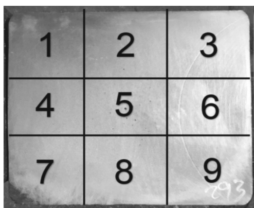
图2 300 mm×340 mm铸坯试样切割示意图
